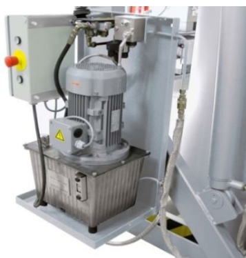
Рисунок 1.3 - Гидравлический агрегат с трудно воспламеняющейся гидравлической жидкостью
