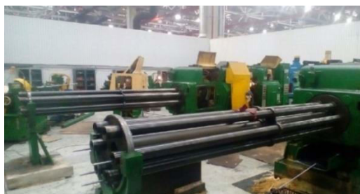
Рисунок 1.5 – Направляющие трубы токарного автомата 1Б240-6К
